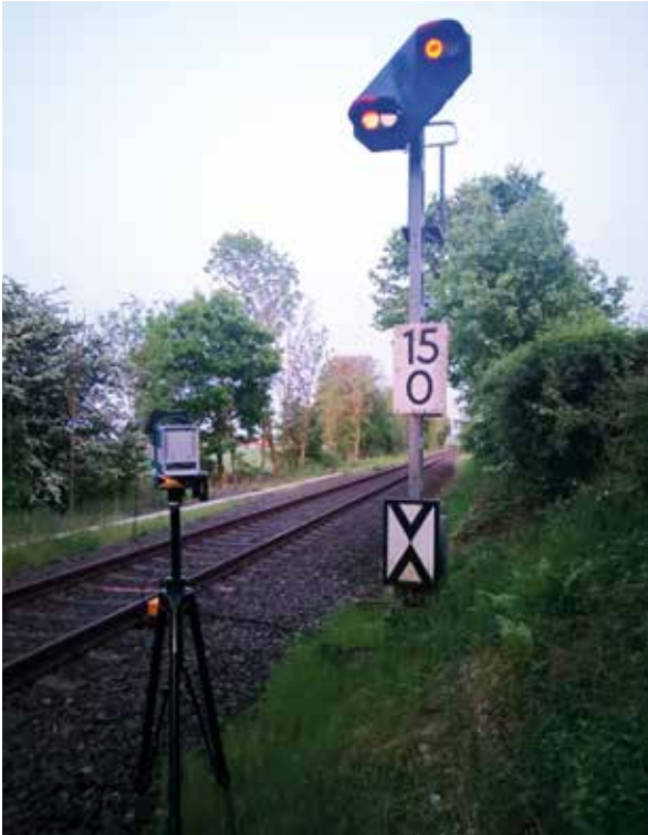
Abb. 3: Der terrestrische Laserscanner Surphaser HSX100SR vor einem Lichtsignal (Vorsignal) am Kilometer 15
