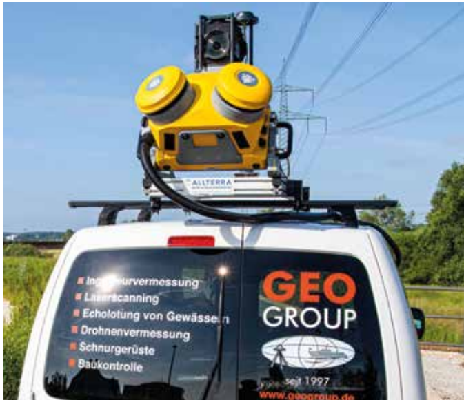
Abb. 1: Trimble MX50 auf einem Autodach
