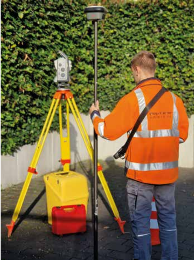
Abb. 1: FX S-Kataster mit dem FZ-G2 und der Leica GS18 GNSS Antenne
